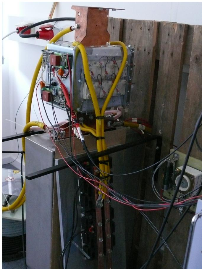
Abbildung 7.2: Detailansicht des Teststands mit Kurzschließer
